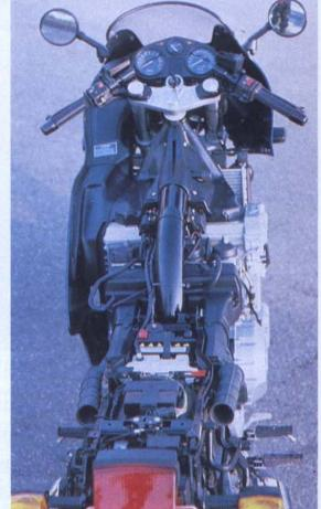
Le large moteur de la Triumph n'est pas en position centrale dans le cadre, mais est légèrement décalé. Les quatre carburateurs à dépression obtiennent leur air frais via des canàlisations venant de l'arrière.
