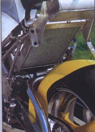
Refroidissement Le radiateur est situé devant la roue arrière, un endroit inhabituel. Pourtant le refroidissement n'a semble-t-il jamais posé de problème.
