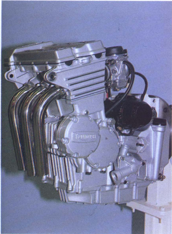
Bien qu'il soit construit étroit et ne pèse que 64 kilos à sec, le moteur du trois cylindres Triumph impressionne par sa taille.
