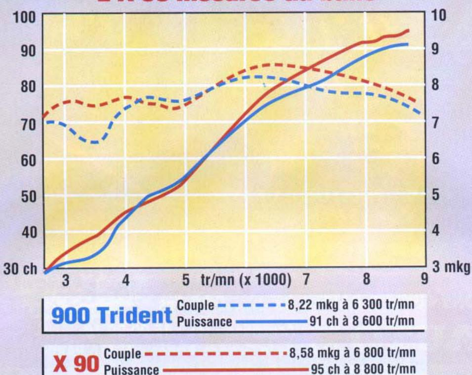
Le montage des pots inox, des filtres à air K&N et le réglage pile-poil de la carburation à base de kit Dynojet ont permis d'obtenir un copieux renforcement du couple à bas et hauts régimes du moteur par rapport au Trident d'origine. De même, la puissance a grimpé de quatre chevaux.
