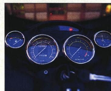
**Tableau de bord** Le compteur a été réétalonné (visez les chiffres : 147 km/h...) sur la roue avant de 14". Les totalisateurs, eux, n'ont pas été modifiés, et il faut compter 900 mètres pour 1 kilomètre inscrit.
