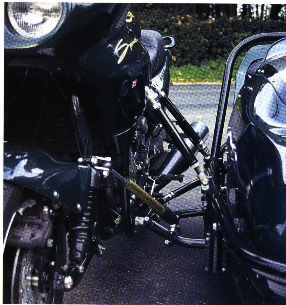
A droites: Le side car quatre points donne la rigidité à l'ensemble; l'amortisseur de direction est solidaire de la fourche et du side.
