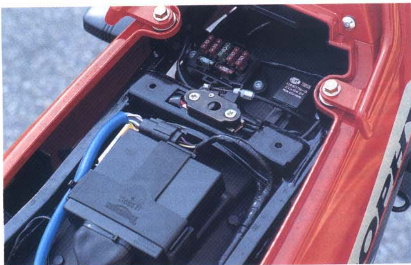
Sous la selle, très accessibles, les boîtiers électroniques, les relais et les fusibles.
